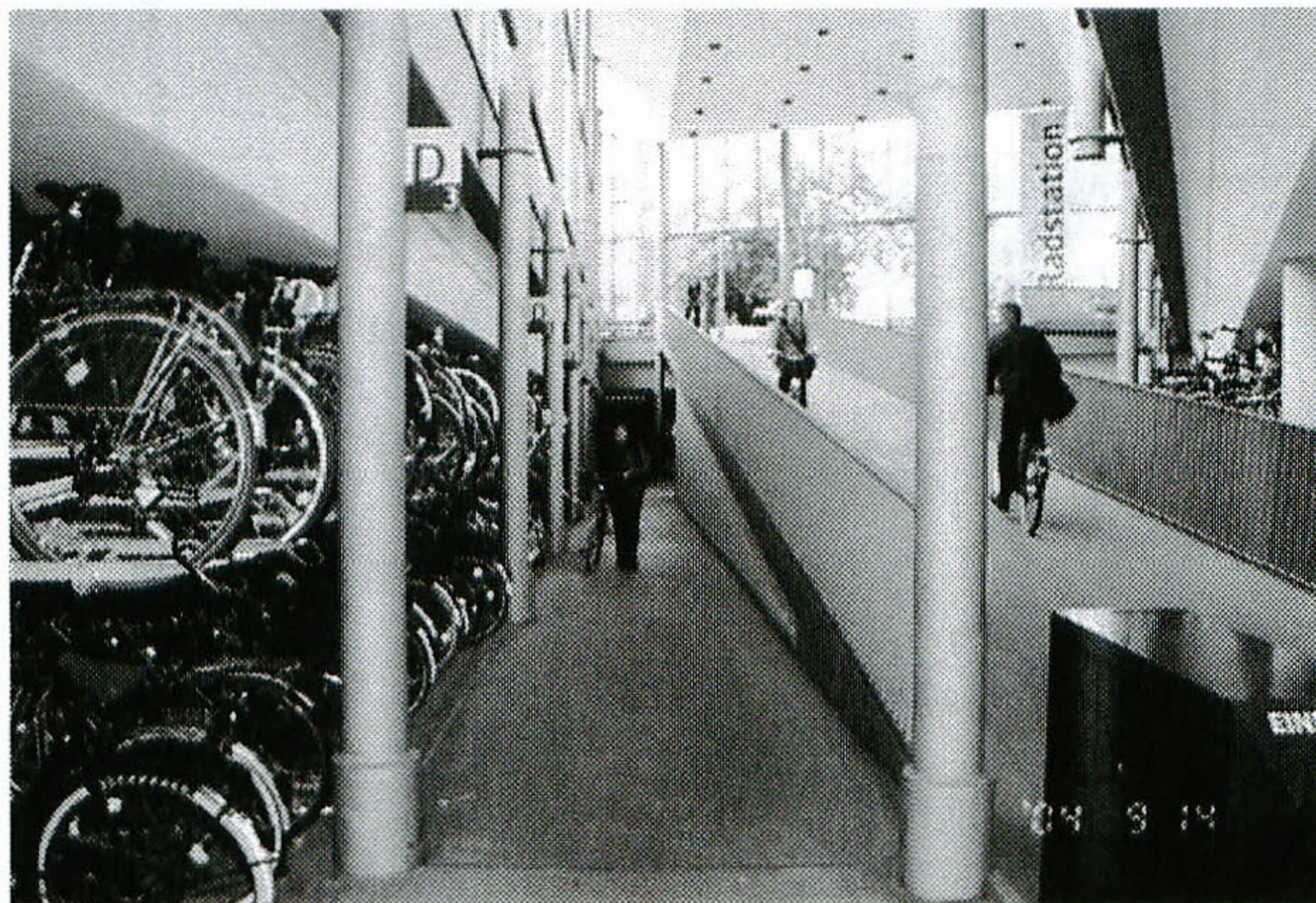
写真 22 左側には2層式ラックタイプに駐輪した自転車が並び、右側には南口からのスロープが見える。スロープには自転車を駐輪するために来た人と、自転車で出て行く人が、それぞれ右側通行をしている。（ミュンスター：2004年9月）
