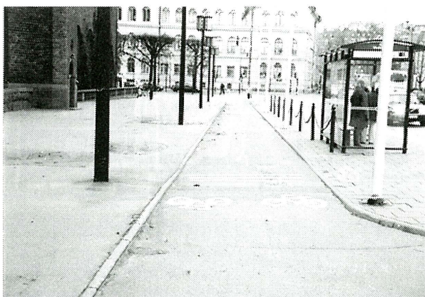
写真4 左側から、歩行者専用レーン、自転車専用レーン、バス乗り場、自動車専用レーン。自転車とバス利用者の安全を確保するため、自転車専用レーンには横断歩道が描かれている。（ストックホルム：2002年11月）
