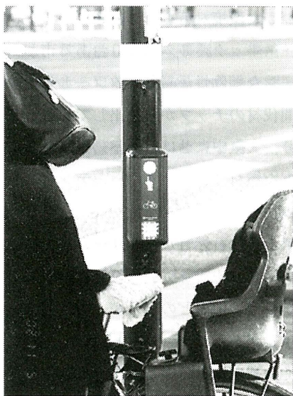
写真3 自転車専用信号機の押しボタン部分。押しボタン部分は歩行者専用信号機と区別するため、自転車のマークが描かれている。ボタンを押すと、ランプが点灯する。（ストックホルム：2002年11月）
