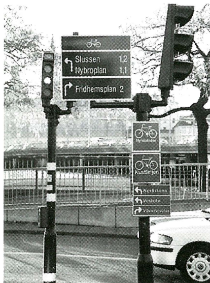
写真2 押しボタン式の自転車専用信号機（左側）。信号機の上部に自転車のマークが見える。地名とその方向および距離を示す標識が立っている。（ストックホルム：2002年11月）
