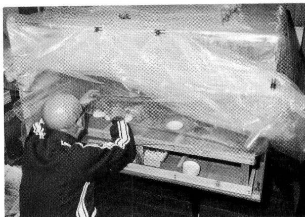
図IX-2 フォルマリン気体鞣装置
