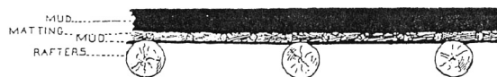
図6 タイトゥスによるマルカタ王宮の天井構造の復原断面図 (Tytus 1903, Fig. 2)
