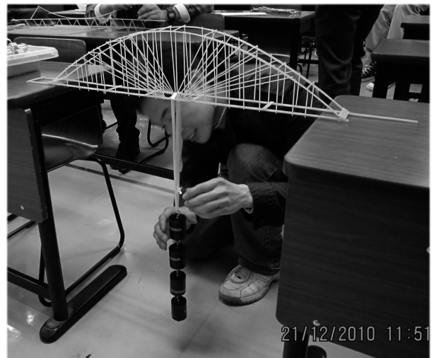
図10 スパゲティブリッジの製作品の例
