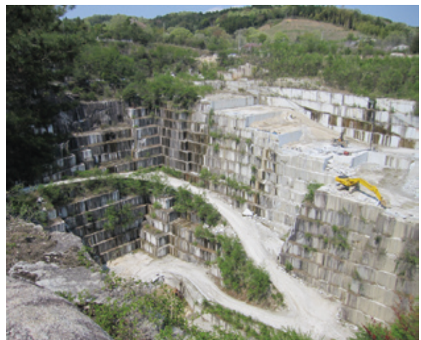
図3. 中野組石材工業株式会社の採石場風景 稲田石の主要な採掘場のひとつで、下方向に掘り進み大きなビットとなっている。写真に見える一段が約3.5メートルである。
