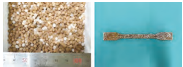
図17 改良した木粉・PLA樹脂ペレットおよびY試験片
