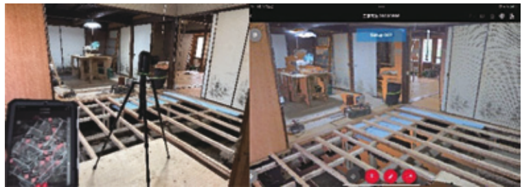
図7 3D スキャナによる実測状況および点群化データ
