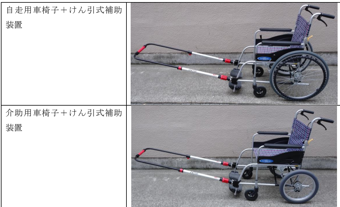
図-26 実験機材（手動車椅子+簡易装着型けん引式車椅子補助装置） 148)
