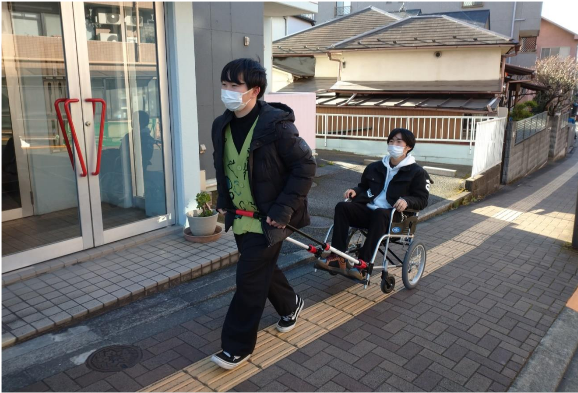
図-27 けん引式補助装置を装着して急勾配部を上っている状況 (③地点)
