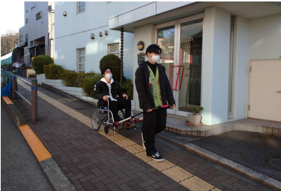
図-28 けん引式補助装置を装着して急勾配部を下っている状況 (③地点)
