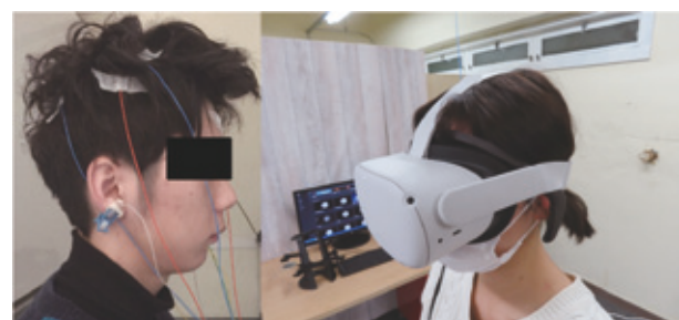
図2 脳波計 (国際10-20法) およびHMDの装着状況
