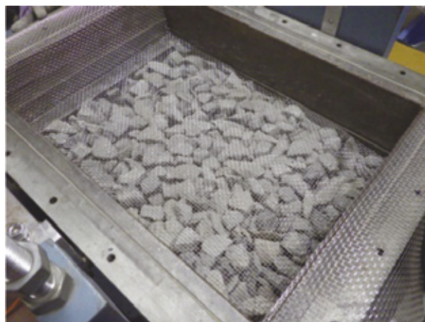
写真-10 金網設置状況
