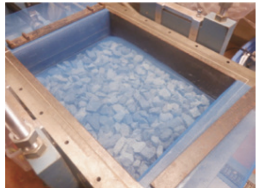
写真-5 ジオグリッド模型N-2設置状況（目合い1倍）
