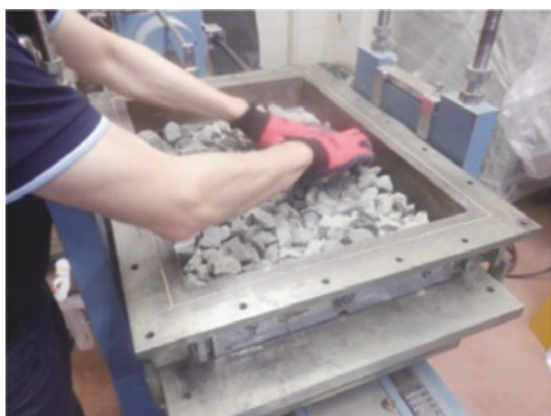
写真-3 碎石充填状況
