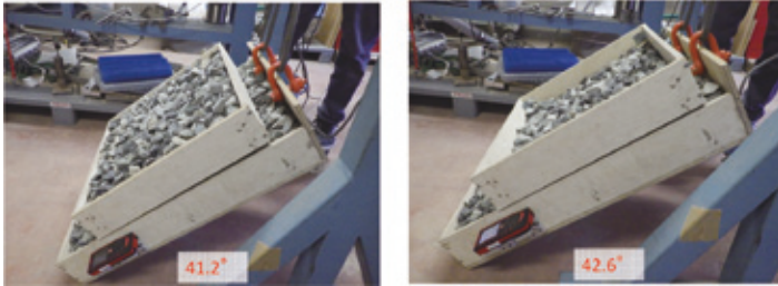
写真-4 簡易一面せん断試験の状況（碎石単体）
