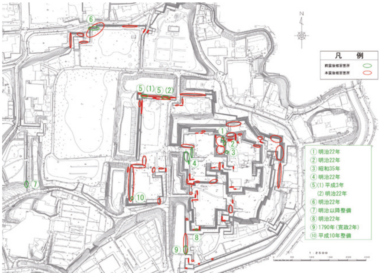
図-5 熊本地震（前震＋本震）による石垣被害状況
