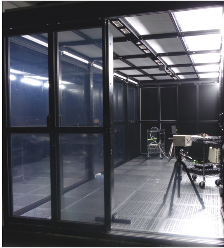
図 5. 可視化実験用クリーンルーム
