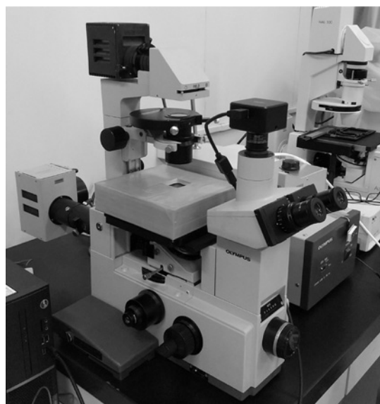
図2 保温ケース（ダンボール+発泡スチロール）と顕微鏡 IMT2
