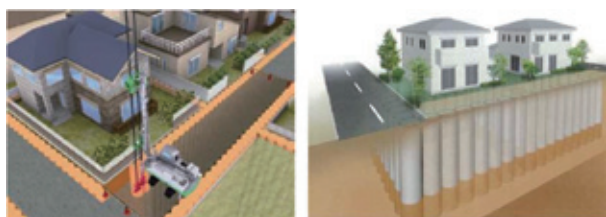
図-17 格子状地中壁工法のイメージ
