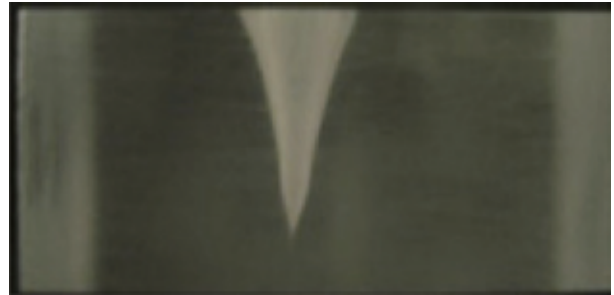
図4 ガウシアン分布モードレーザーを照射したアクリル材の加工痕
