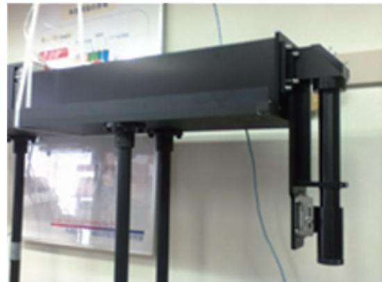
図6 トップハット化光学系を組み込んだCO 2 レーザーシステム
