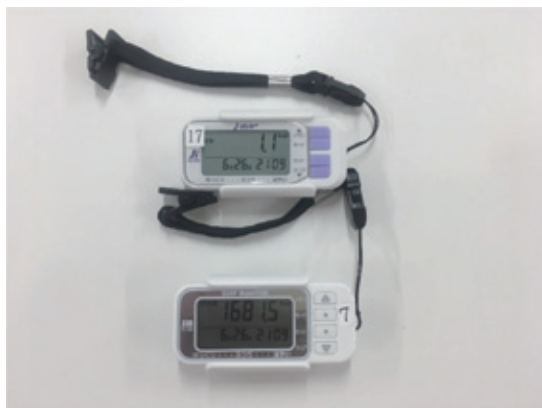
図4 睡眠状態および身体活動量を計測する活動計 (アコズ社製Sleep Monitor FS-760, FS-770)
