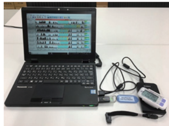
図5 身体活動データ受信器および睡眠解析ソフト (キッセイコムテック社製Sleep Sign Act2)
