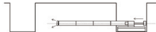
④ 方向修正を行いながら、推進用鋼管を順次推進する
