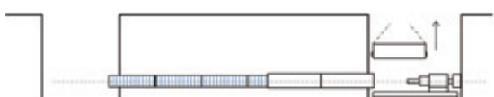
⑧ 集排水パイプを所定の位置まで挿入した後、推進用鋼管を引き抜く
