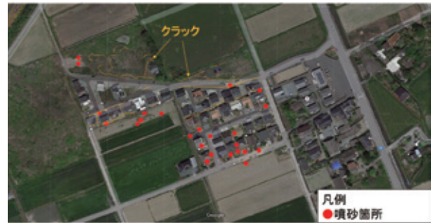
写真-1 芝原団地の噴砂及び地割れ(クラック)状況
