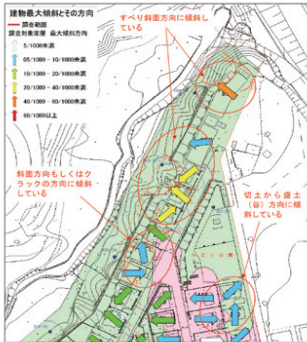
図-17 北側宅地エリアの家屋最大傾斜
