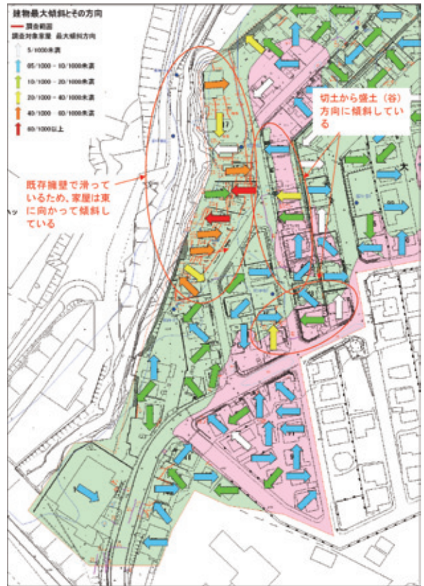
図-19 南側宅地エリアの家屋最大傾斜
