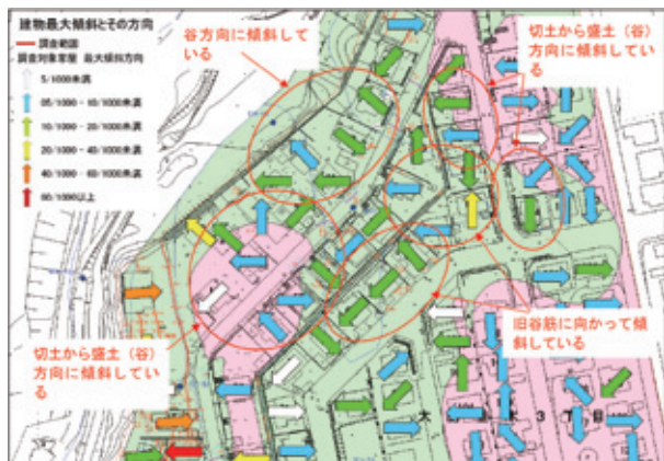
図-18 中央宅地エリアの家屋最大傾斜
