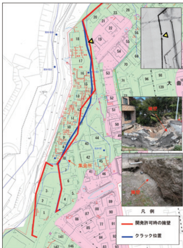
図-22 南側宅地エリアの擁壁位置
