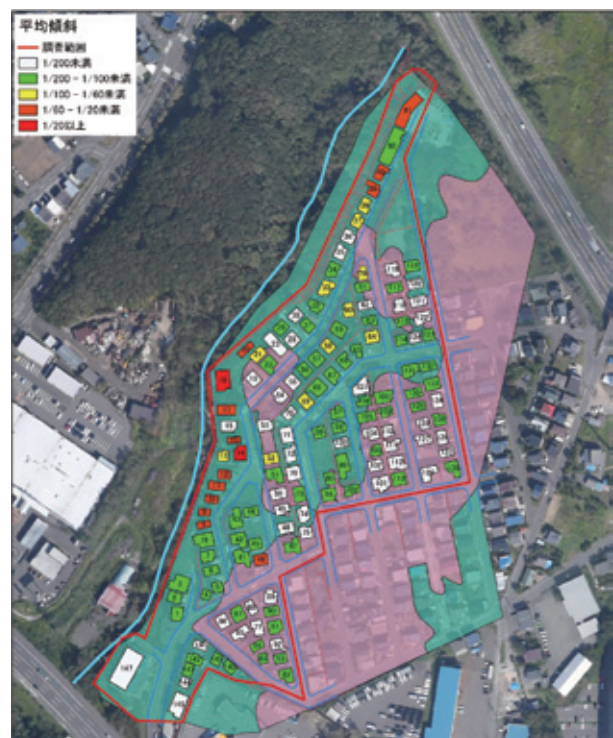
図-16 建物の平均傾斜 7)
