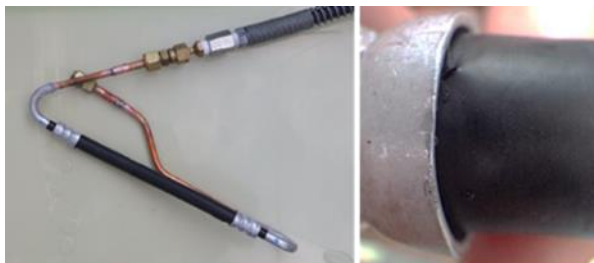
Fig. 77 ゴムホース配管の耐圧試験結果
