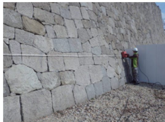
写真-4 地中レーダ探査測定状況
