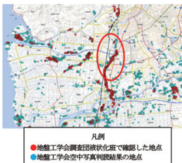
凡例 ● 地盤工学会調査団液状化班で確認した地点 ● 地盤工学会空中写真判読結果の地点 図-1 熊本地震による液状化発生箇所 2)
