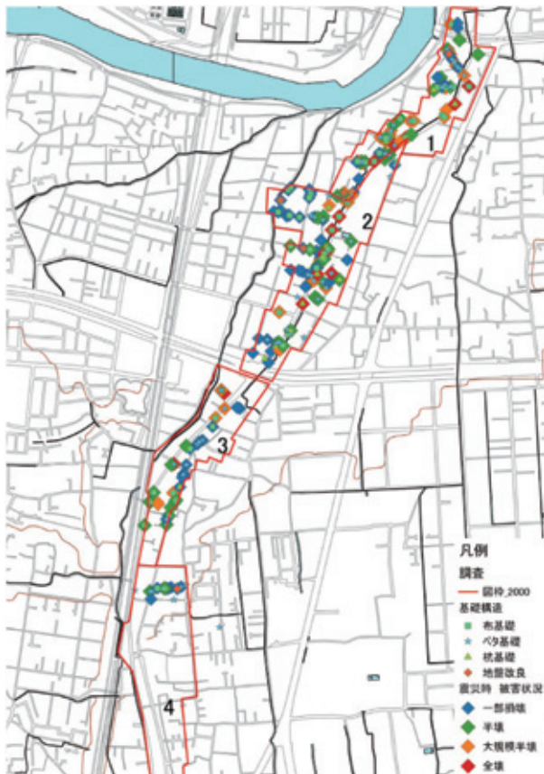
図-14 住宅基礎構造と被害状況の重ね図
