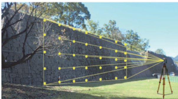
図-3 3Dレーザスキャナの測定イメージ
