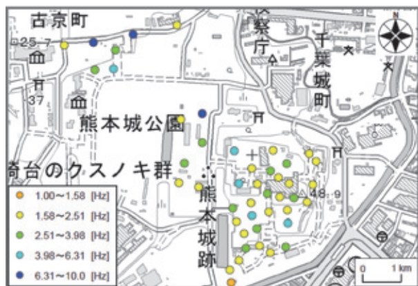
図-1 熊本城内でのH/Vスペクトルのピーク周波数の分布 1-3)
