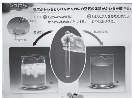
図2 空気の体積変化の実験
