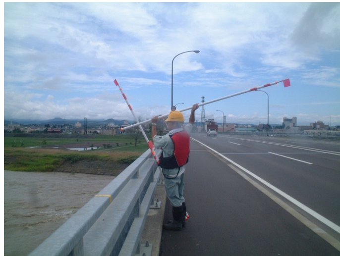
図 1-8 浮子投下時の風景
