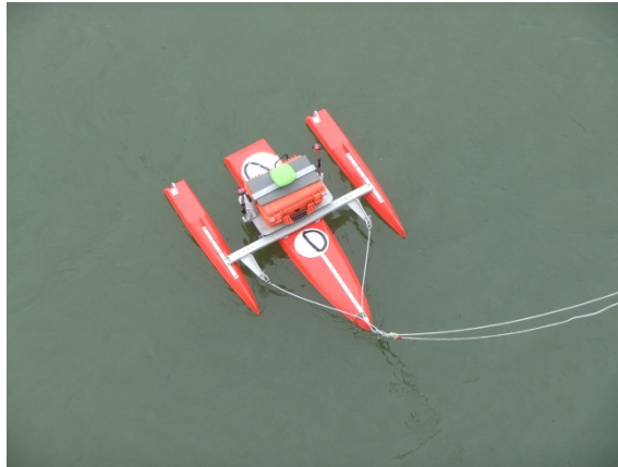
図 1-12 ADCPおよび周辺機器を搭載した橋上操作艇
