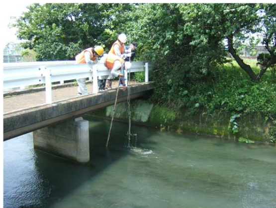
図 1-5 低水流量観測の風景（橋上からの観測）
