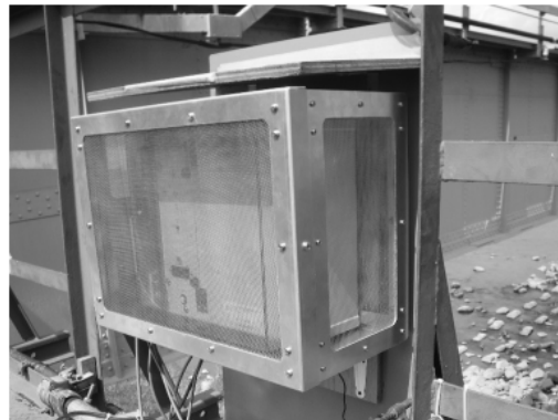
図 4.7.14 電磁波対策用の金属箱
