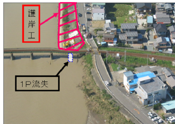
図 3.2.39 H橋梁被災状況
